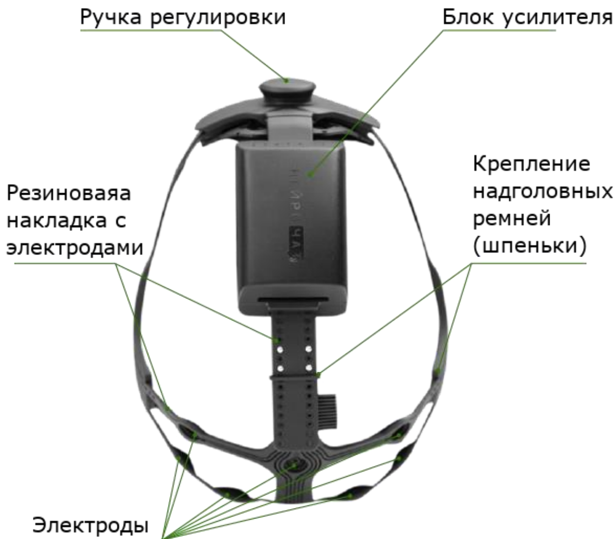
Рисунок 3. Схема нейрогарнитуры «ГарАнт-ЭЭГ»
